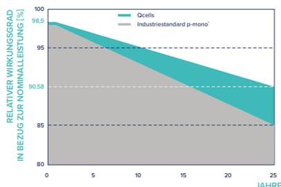
Mindestens 98,5% der Nennleistung innerhalb des ersten Jahres. Danach max. 0,33% Degradation pro Jahr. Mindestens 95,53% der Nennleistung nach 10 Jahren. Mindestens 90,58% der Nennleistung nach 25 Jahren.
